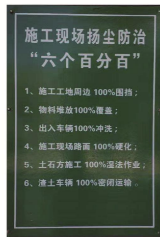
施工现场扬尘防治“六个百分百”告知牌
